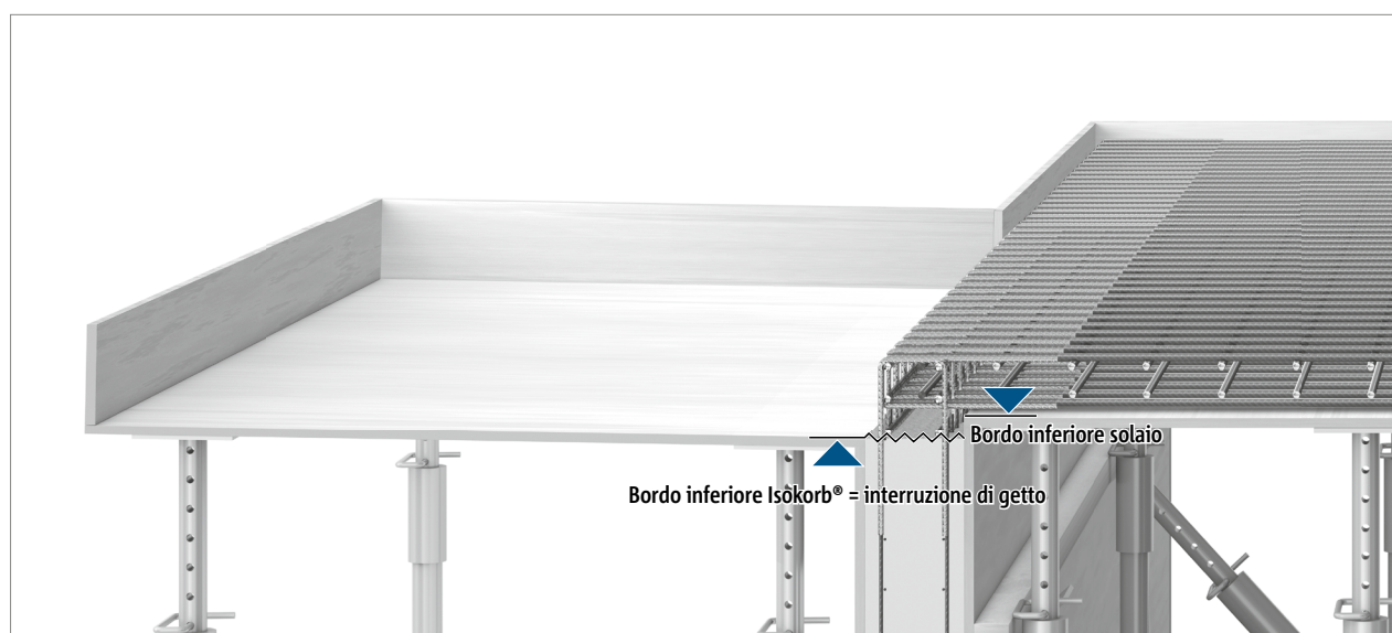
Fig. 39: Schöck Isokorb® T tipo KL: preparazione del cassero e dell'armatura per il getto. Interruzione di getto parete = intradosso balcone!
