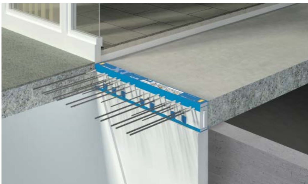
Foto 3 - Taglio termico : il giunto Isokorb® viene posato tra la soletta a sbalzo e il pavimento interno Foto ©Schöck
