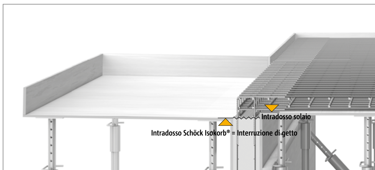
Fig. 50: Schöck Isokorb® tipo K: preparazione del cassero e dell'armatura per il getto. Schöck Isokorb® tipo K: preparazione del cassero e dell'armatura per il getto.
