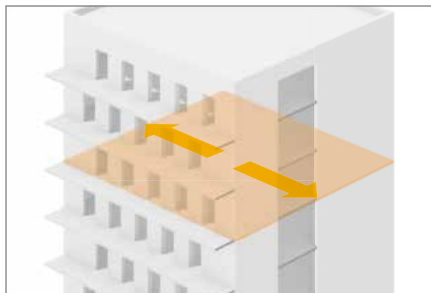
Fig. 23: direzione del movimento parallela al giunto isolante
