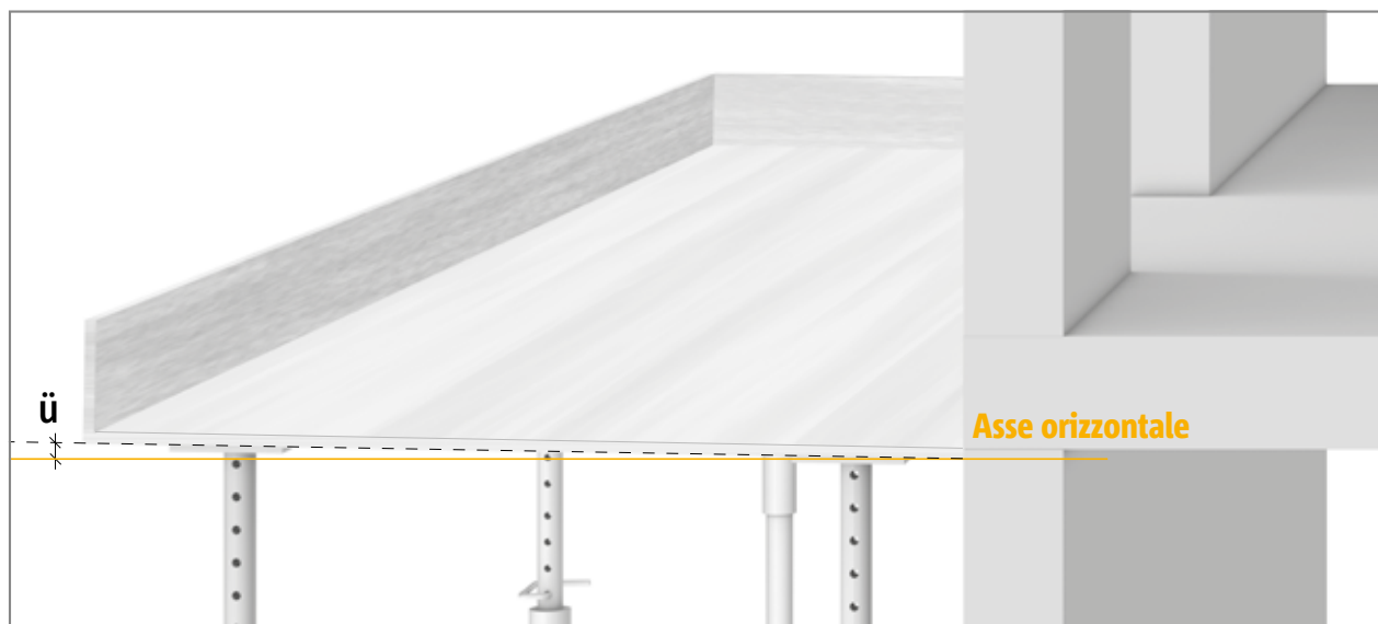
Fig. 32: controfreccia dalla cassaforma
